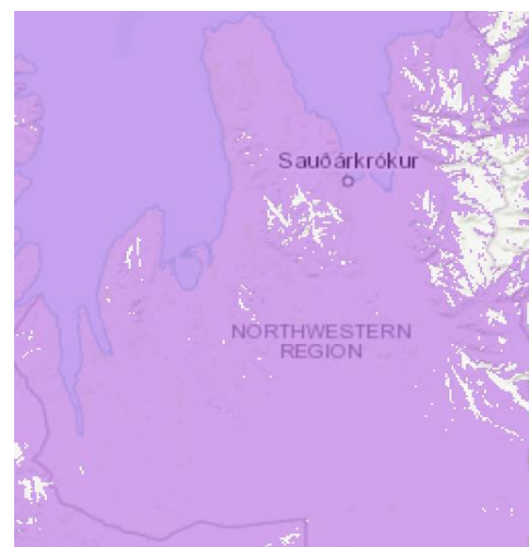
Mynd 20. Samanlagt dreifikerfi Símans, Vodafone og Nova fyrir 4G á Íslandi í júlí 2021 miðað við ákveðnar forsendur, fjólublátt merkir 4G-samband. Mynd, Fjarskiptastofa.
